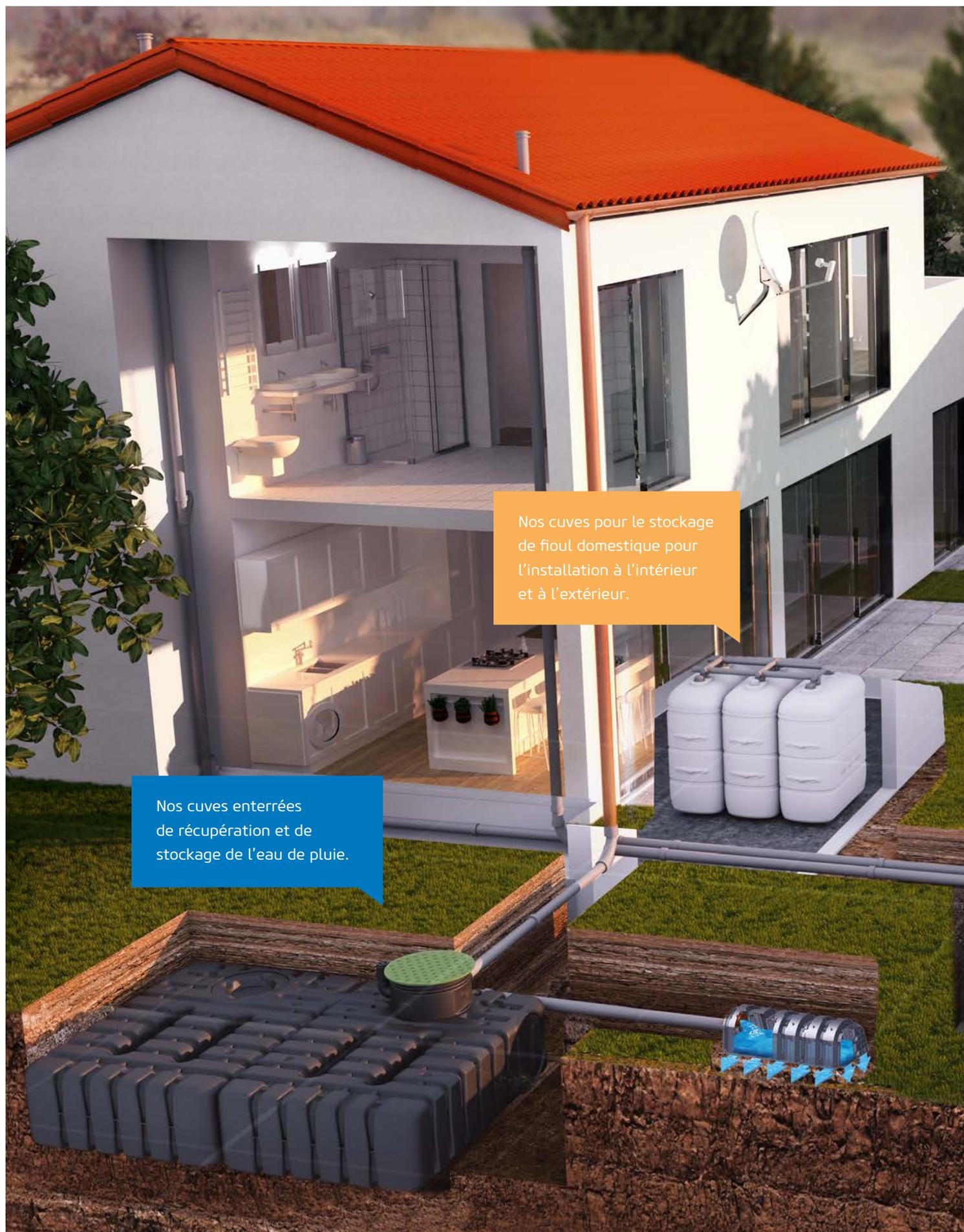
Nos cuves pour le stockage de fioul domestique pour l'installation à l'intérieur et à l'extérieur.
