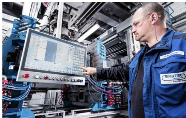
En plus des caractéristiques intrinsèques communes à la technique d'extrusion-soufflage, RIKUTEC utilise cette technologie multi couches pour adapter la fabrication des produits au domaine d'utilisation (par exemple la couche de polyéthylène alimentaire ou de couleur).
