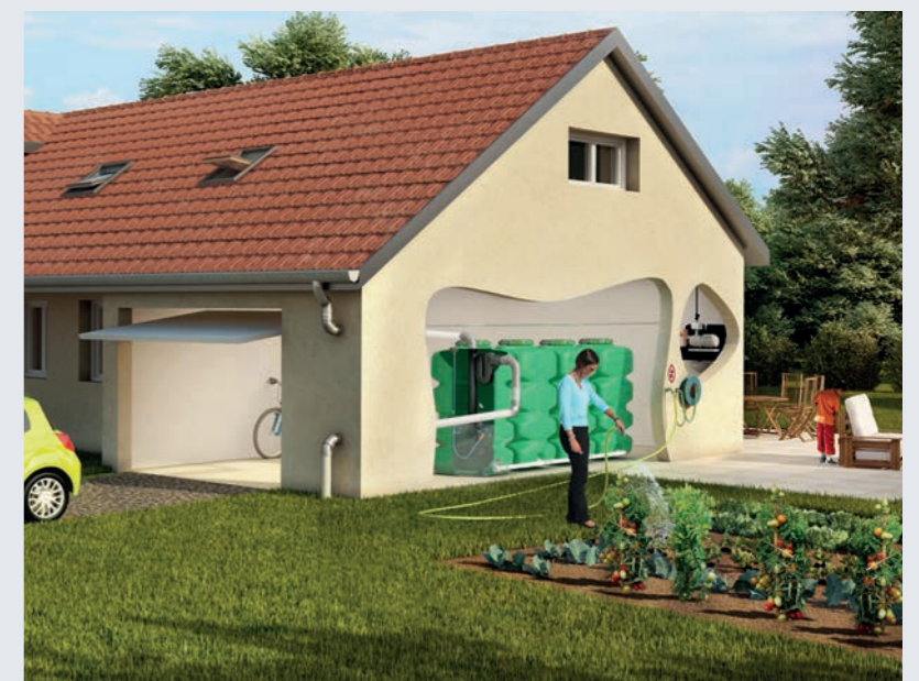
(Einbauschema AquaVario als Batterieaufstellung)
